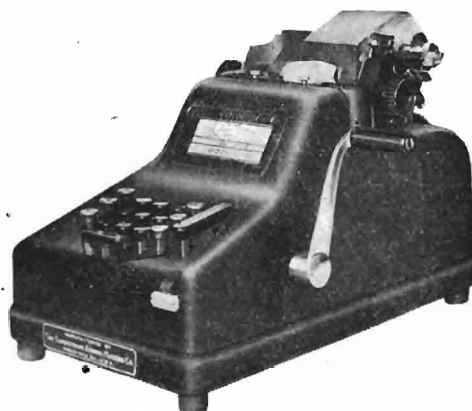
ADDIZIONATRICE CON TASTIERA RIDOTTA A FUNZIONAMENTO MANUALE
